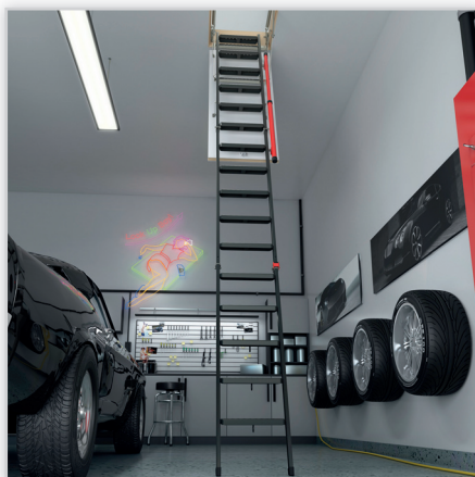
Schody LMP. Wyposażenie: biała kłapa termoizolacyjna, ukryty w poręczy mechanizm odciążający drabinkę, stopki. Cechy szczególne: do wysokich pomieszczeń. Maks. wys. pomieszczenia [cm]: 366. Maks. dopuszczalne obciążenie [kg]: 200. Izolacja termiczna [cm]: 3.
