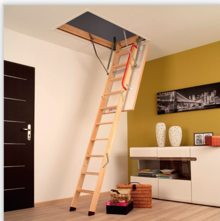
Schody LWS Plus/LWK Plus. Wyposażenie: LWS Plus – beżowa kłapa termoizolacyjna, LWK Plus – biała kłapa termoizolacyjna, poręcz, plastikowe stopki. Cechy szczególne: prosty montaż i demontaż kłapy, innowacyjne rozwiązania konstrukcyjne dla większego komfortu i bezpieczeństwa. Maks. wys. pomieszczenia [cm]: 280 i 305. Maks. dopuszczalne obciążenie [kg]: 160. Izolacja termiczna [cm]: 3.
